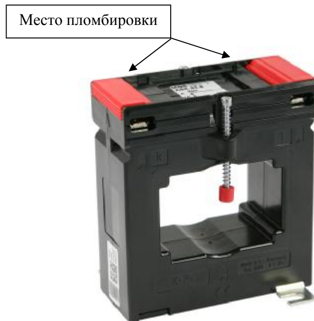
Рисунок 1 – Общий вид средства измерений и схема пломбировки от несанкционированного доступа
