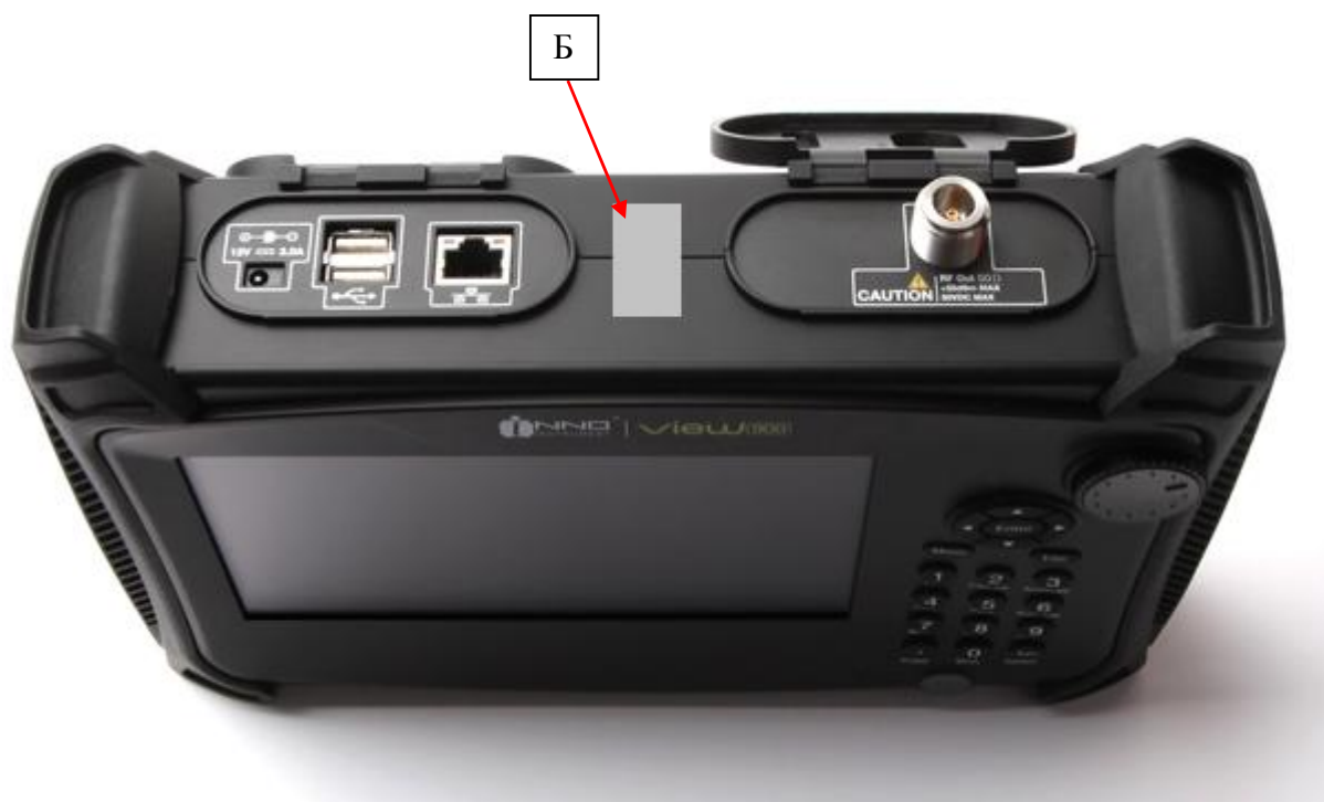
Рисунок 2 – Схема пломбировки анализаторов от несанкционированного доступа (Б)
