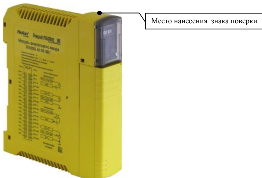
Рисунок 2 - Общий вид модулей аналогового ввода/вывода из состава контроллера
