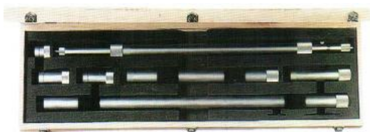
Рисунок 1 – Общий вид нутромеров модели НМ
