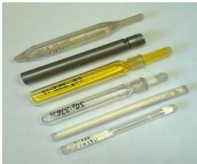
Рисунок 1 – Общий вид источников микропотоков газов и паров ИМ-ЭС различных конструктивных исполнений
