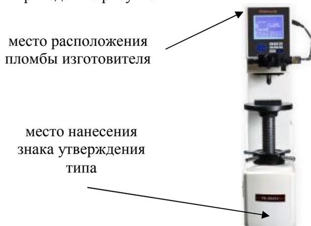
Рисунок 1 – Общий вид твердомеров ТБ 5015С Tochline
