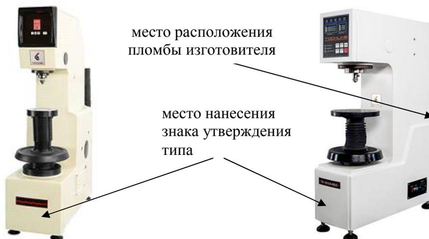
Рисунок 2 – Общий вид твердомеров
