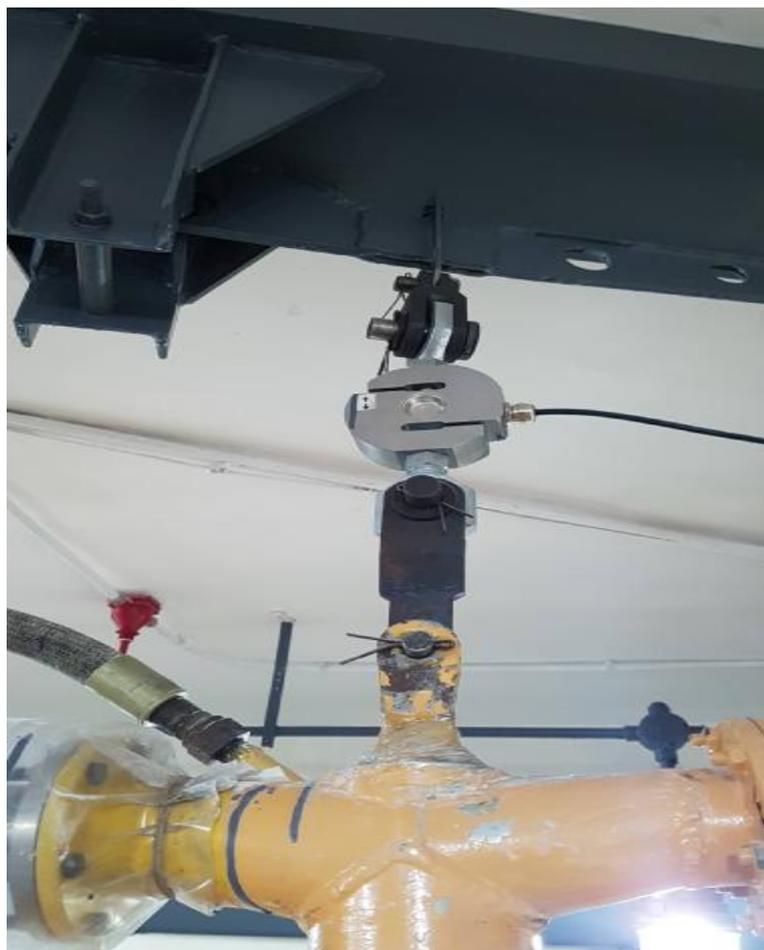
Рисунок 5 – Датчик весоизмерительный тензорезисторный С2Н-1-С3
