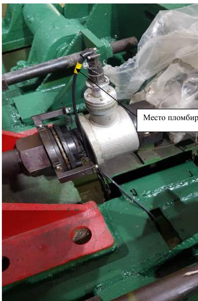
Рисунок 8 – Тензорезисторный датчик ТВС-2
