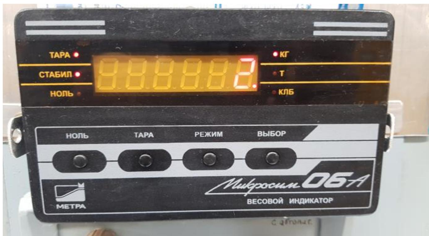
Рисунок 6 – Прибор весоизмерительный Микросим-06
