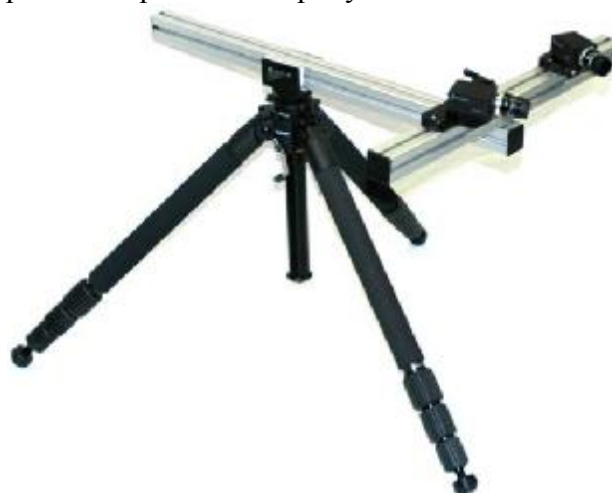
Рисунок 1 - Внешний вид измерителей перемещений (деформаций) оптических бесконтактных серии Vic
