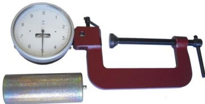
Рисунок 1 - Общий вид прогибомера ПМ
