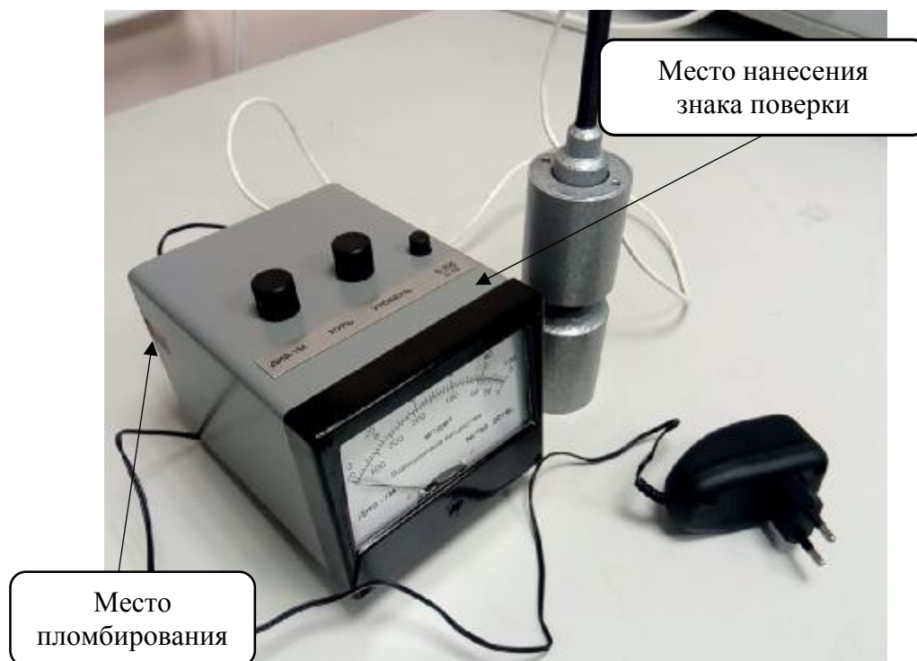
Рисунок 1 – Общий вид анализаторов, обозначение места нанесения знака поверки и схема пломбировки от несанкционированного доступа
