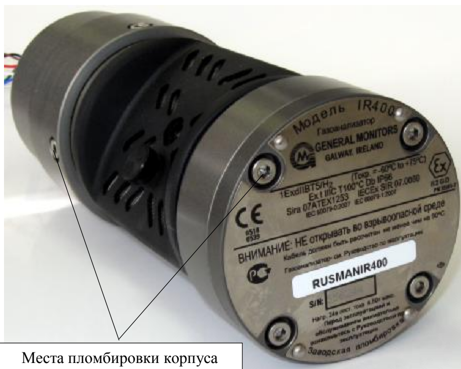
Рисунок 2 - Места пломбировки корпуса газоанализатора для ограничения несанкционированного доступа
