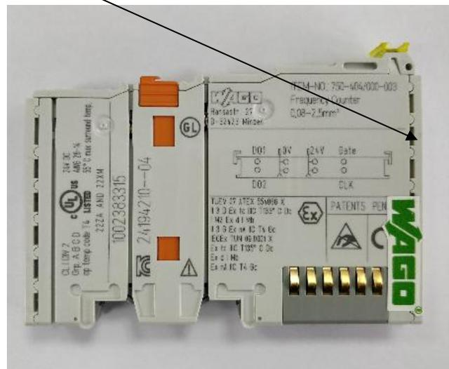
Рисунок 4 - Общий вид модуля ввода частотных сигналов (750-404/000-003)
