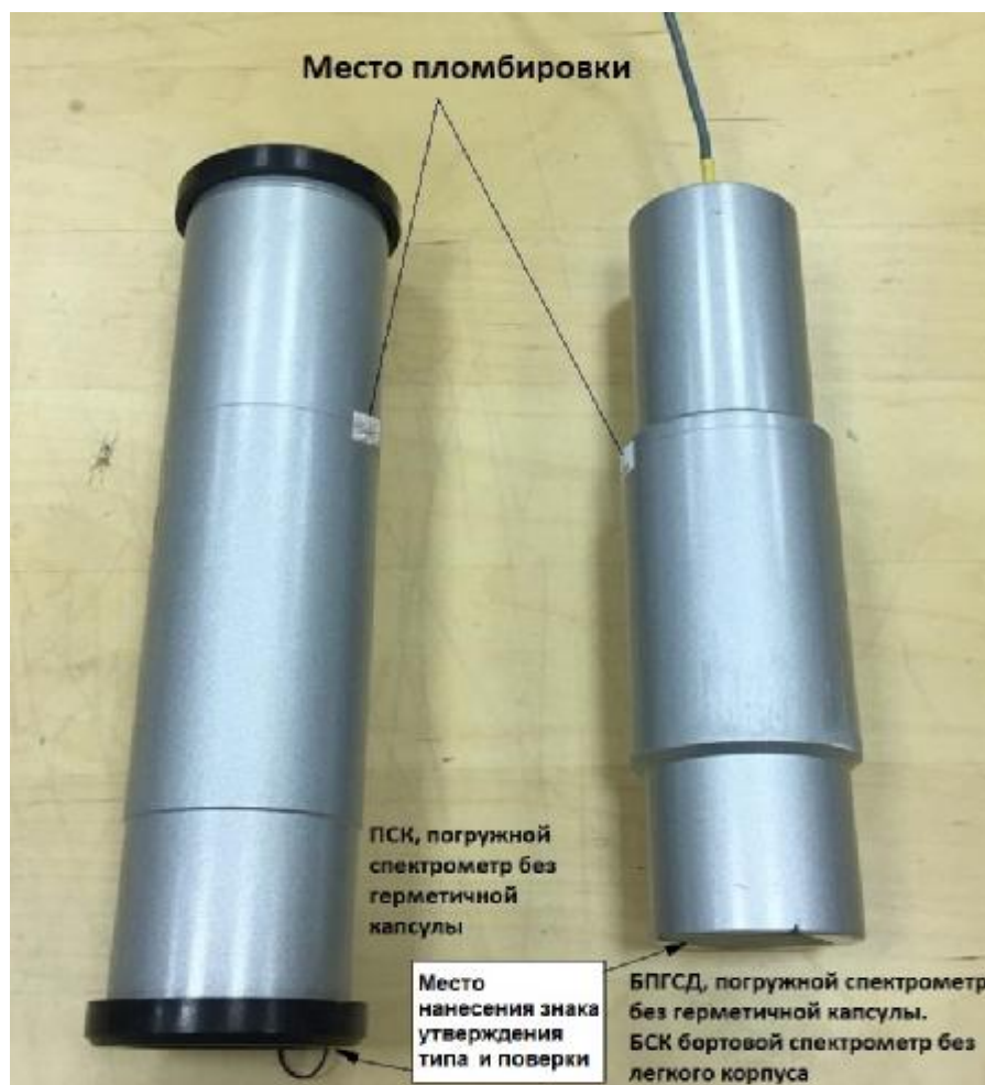
Рисунок 3 – Схема пломбировки от несанкционированного доступа, обозначение места нанесения знака поверки и утверждения типа
