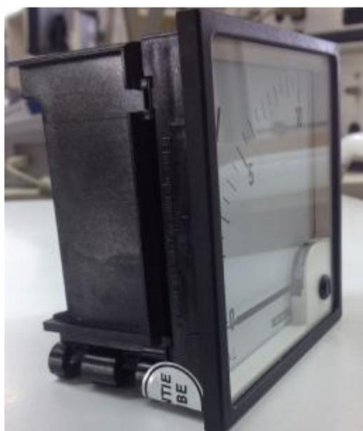
Рисунок 6 - Место пломбирования прибора наклейкой в диэлектрическом пластиковом корпусе
