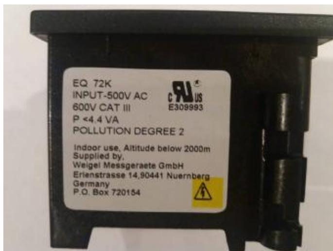
Рисунок 5 - Место нанесения данных о типе и модификации прибора
