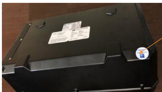
Рисунок 3 - Схема пломбировки от несанкционированного доступа счетчиков аэрозольных частиц Lighthouse модификации ApexZ (задняя панель корпуса)
