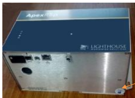
Рисунок 4 - Схема пломбировки от несанкционированного доступа счетчиков аэрозольных частиц Lighthouse модификации ApexR (задняя панель корпуса)
