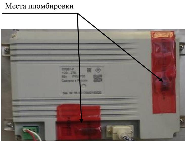
Рисунок 3 – Пломбировка панели оператора ШП
