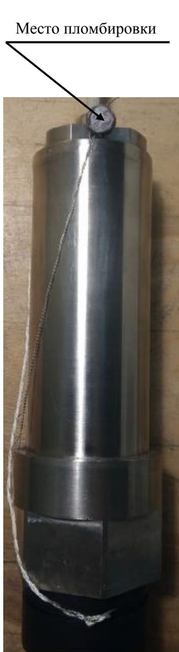
Рисунок 2 – Пломбировка МКЛП
