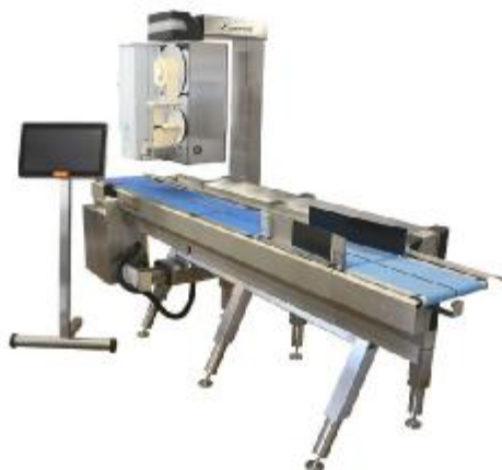
а) АБУ с выносным дисплеем терминала расположенным на стойке
