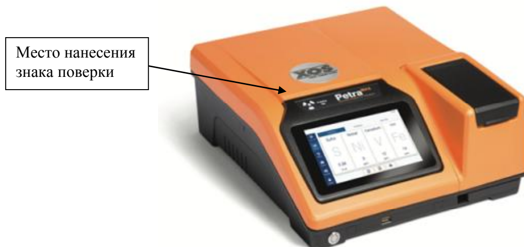
Рисунок 1 – Общий вид анализаторов рентгенофлуоресцентных Petra
