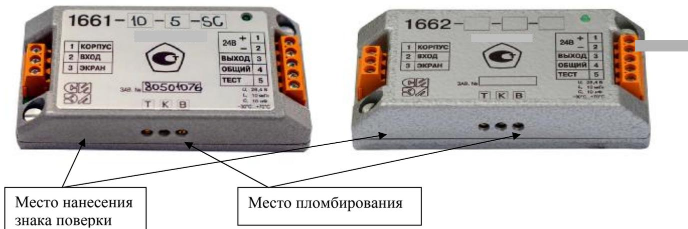
Рисунок 2 - Общий вид генераторов-преобразователей СИЭЛ-1661 и СИЭЛ-1662
