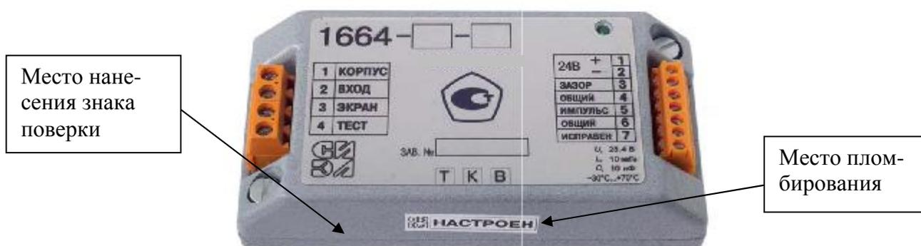
Рисунок 5 - Общий вид генератора-преобразователя СИЭЛ-1664
