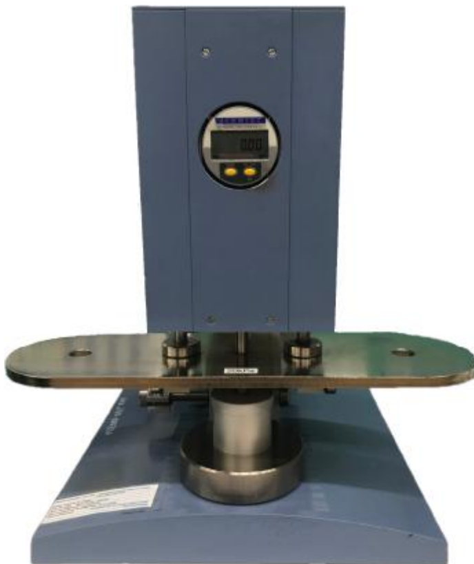
Рисунок 1 – Общий вид толщиномера автоматического D 2000
