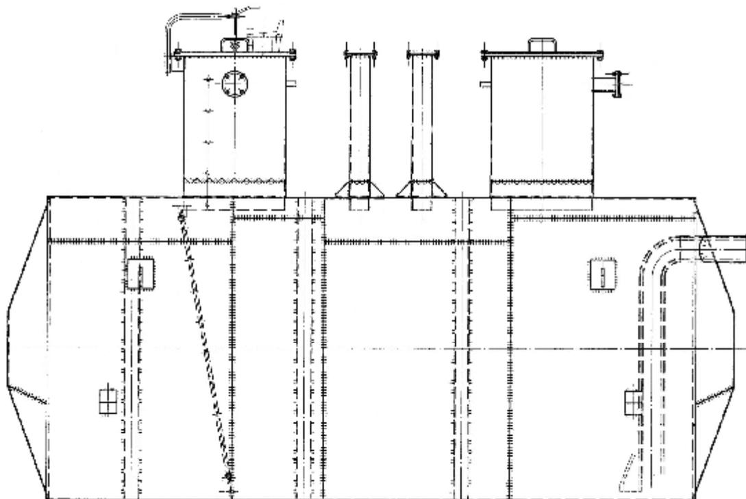
Рисунок 1 – Эскиз резервуаров РГС-40
