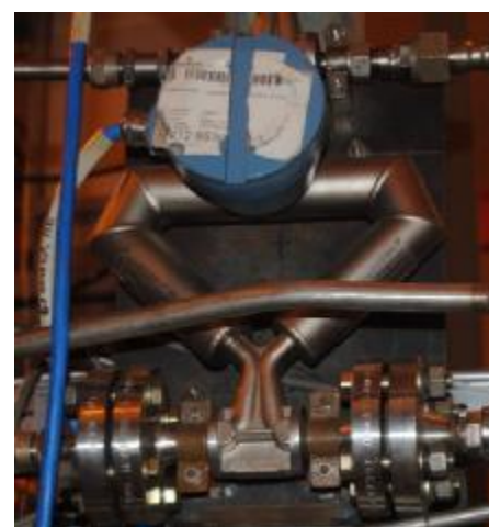
Рисунок 4 - Преобразователь расхода массового. Вид внешний
