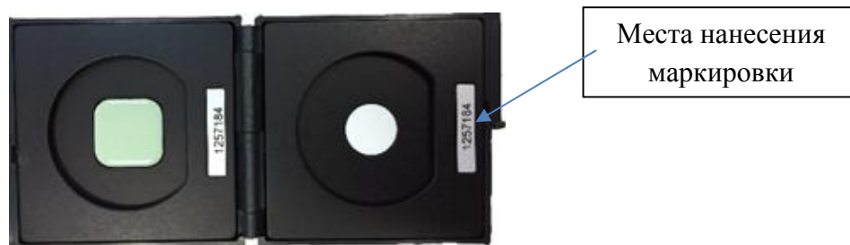
Рисунок 3 – Калибровочный белый стандарт и проверочный цветной стандарт с обозначением места нанесения маркировки
