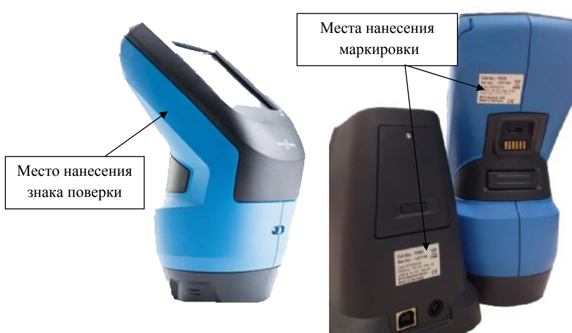
Рисунок 2 – Обозначение места нанесения знака поверки и маркировки
