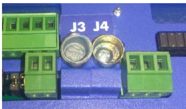
Рисунок 2 – Схема пломбировки от несанкционированного доступа, обозначение места нанесения знака поверки уровнемеров ультразвуковых ВЗЛЕТ УР мод. 212
