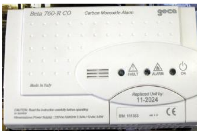
в) Beta 760-R CO с внешним детектором Beta gas detector 756-R/M
