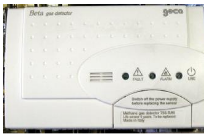
в) Beta 760-R CO с внешним детектором Beta gas detector 756-R/M
