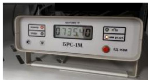
Рисунок 12 – Преобразователь давления абсолютного БРС-1М. Вид внешний
