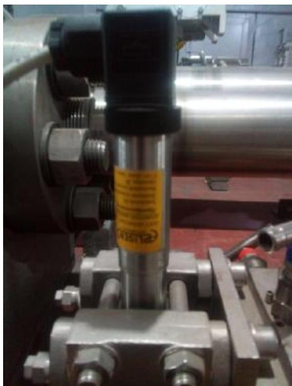
Рисунок 11 – Датчик перепада давления АРС-2000PD. Вид внешний
