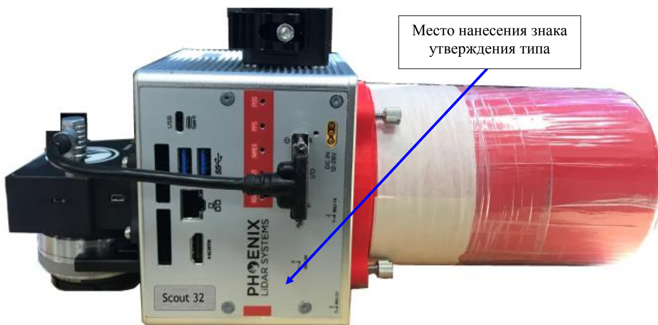
Рисунок 2 - Внешний вид сканеров лазерных мобильных Phoenix Scout 32
