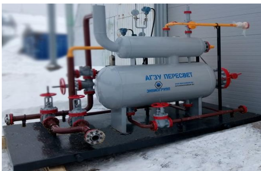
Рисунок 1 – Внешний вид установки измерительной групповой автоматизированной «АГЗУ-ПЕРЕСВЕТ»
