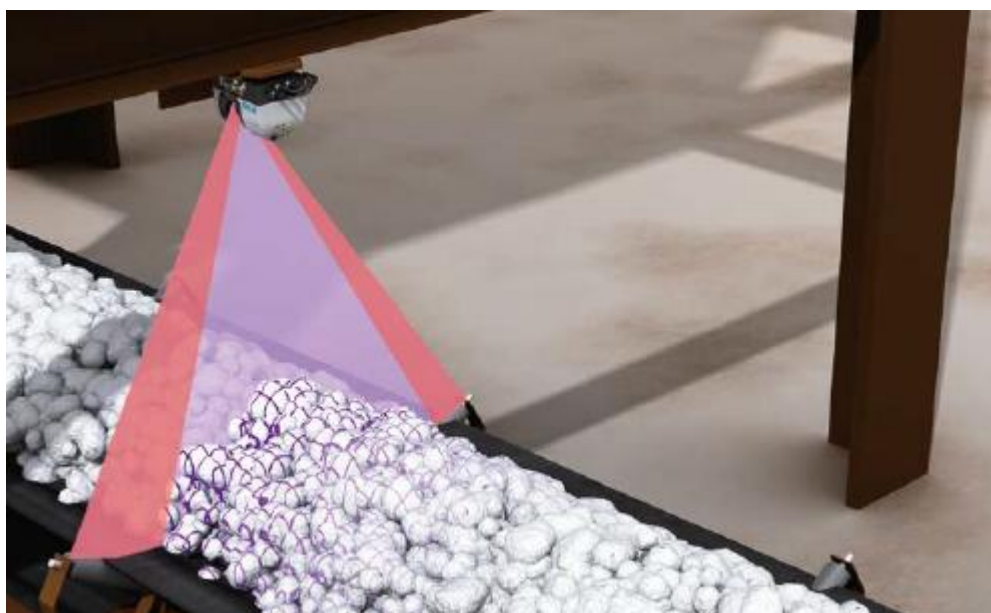
Рисунок 2 – Схема размещения лазерного сканера над ленточным конвейером
