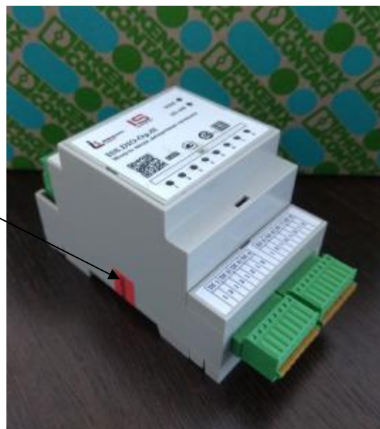
Рисунок 2 – Общий вид модулей ISS.DIO с обозначением схемы пломбировки от несанкционированного доступа для серии Optimal
