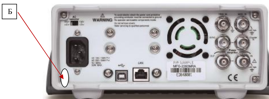
Рисунок 4 – Вид задней панели и место опломбирования от несанкционированного доступа (Б)
