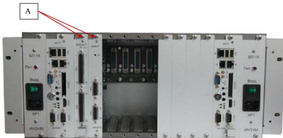
Рисунок 1 – Общий вид контроллеров и схема пломбировки от несанкционированного доступа (А)
