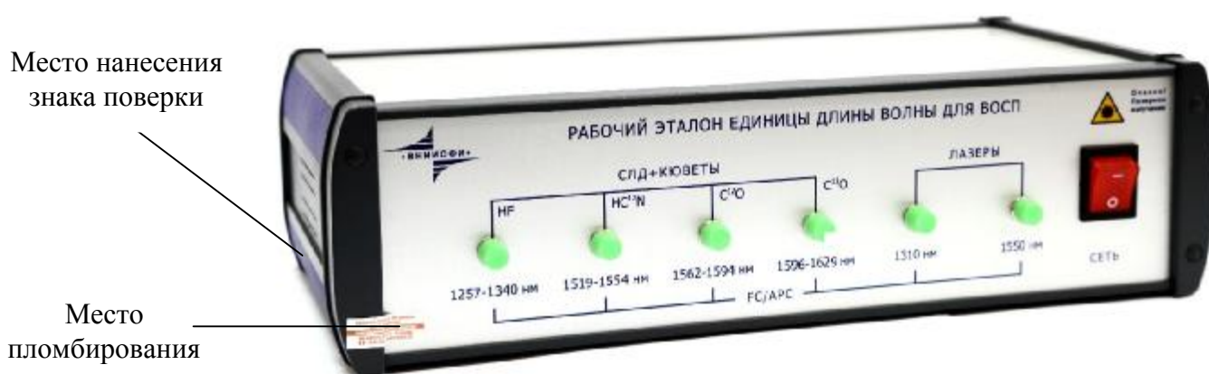
Рисунок 1 – Общий вид эталона со схемой пломбировки от несанкционированного доступа и обозначение места нанесения знака поверки
