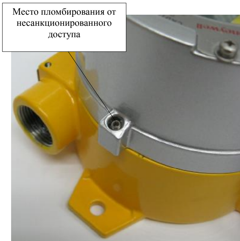
Рисунок 2 – Схема пломбирования газоанализаторов от несанкционированного доступа
