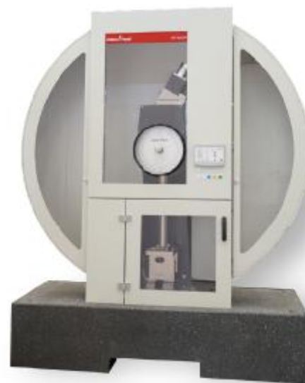
Рисунок 4 – Общий вид копров маятниковых HIT300P, HIT450P
