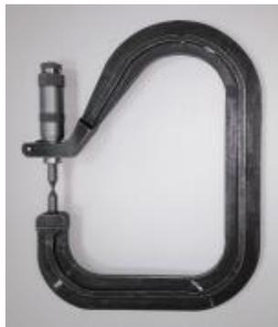
Рисунок 2 - Общий вид скобы микрометрической специальной модификации 934.8124-0015
