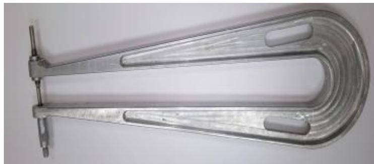
Рисунок 1 – Общий вид скоб микрометрических специальных модификации 934.8124-0013
