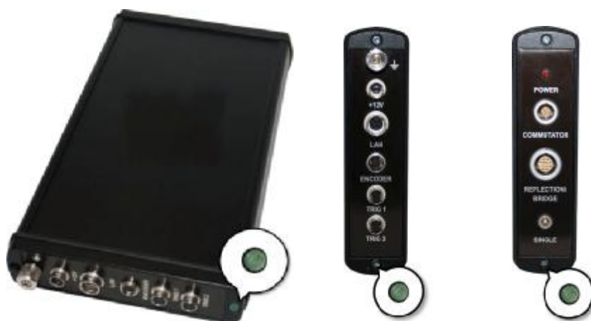
Рисунок 5 – Места пломбировки блоков канальных вихретоковых модулей установки
