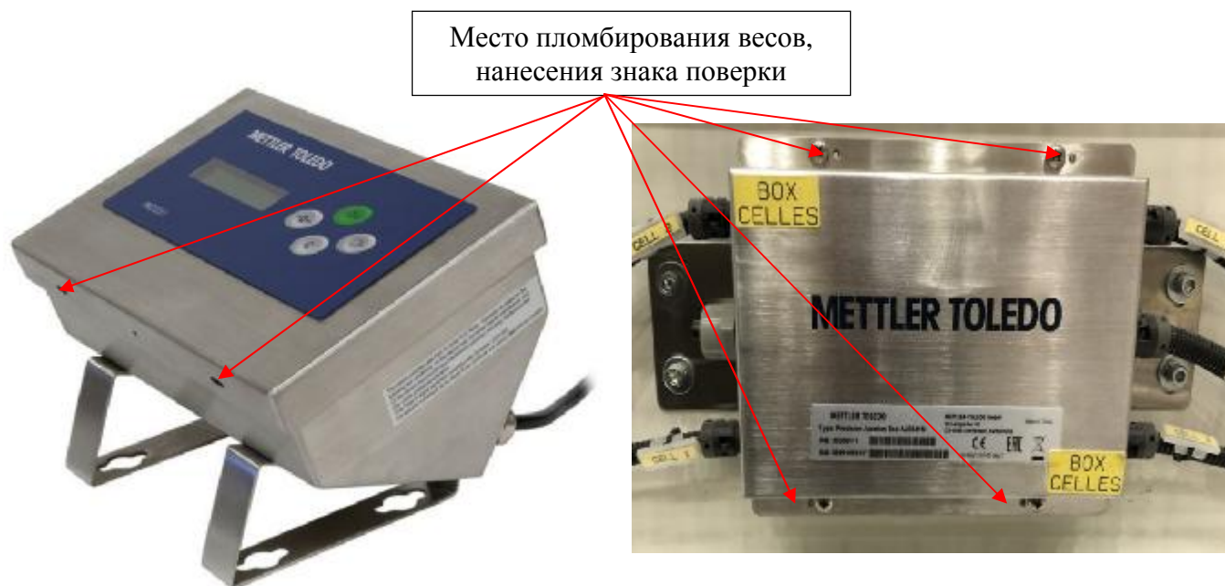
Рисунок 2 - Схема пломбирования весов от несанкционированного доступа, место нанесения знака поверки
