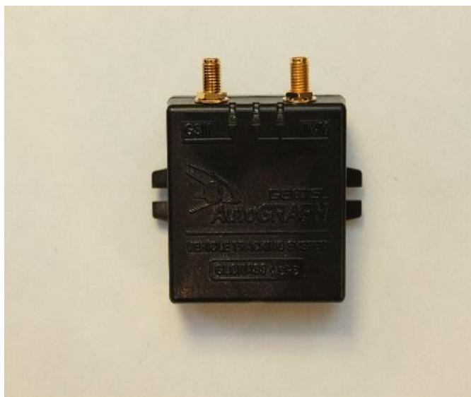
Рисунок 1 – Общий вид контроллера исполнения «АвтоГРАФ-GSM/SL»
