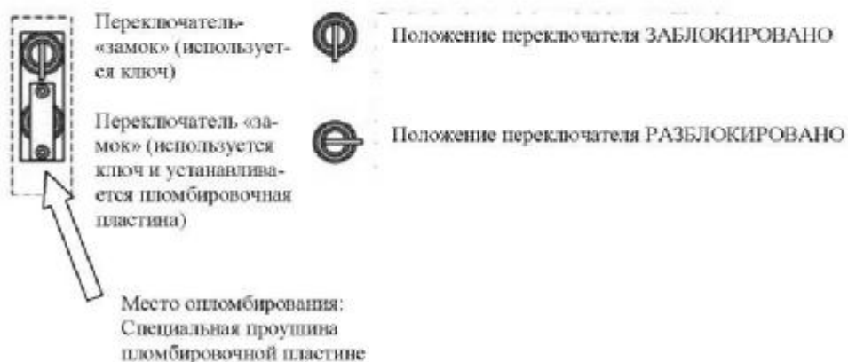
Рисунок 3 – Схема опломбирования (ограничения доступа)
