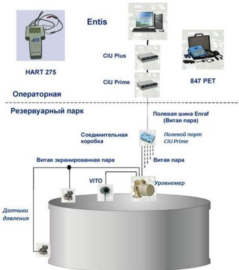
Рисунок 1 – Схема Системы коммерческого учета и контроля резервуарных запасов парка сырой нефти Entis- т.910-11
