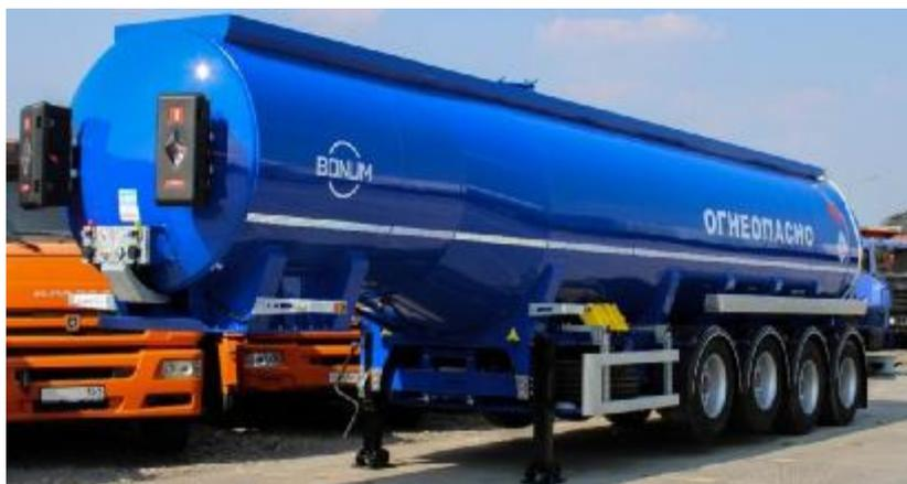
Рисунок 1 - Общий вид полуприцепа-цистерны BONUM 914221/32 переменного сечения
