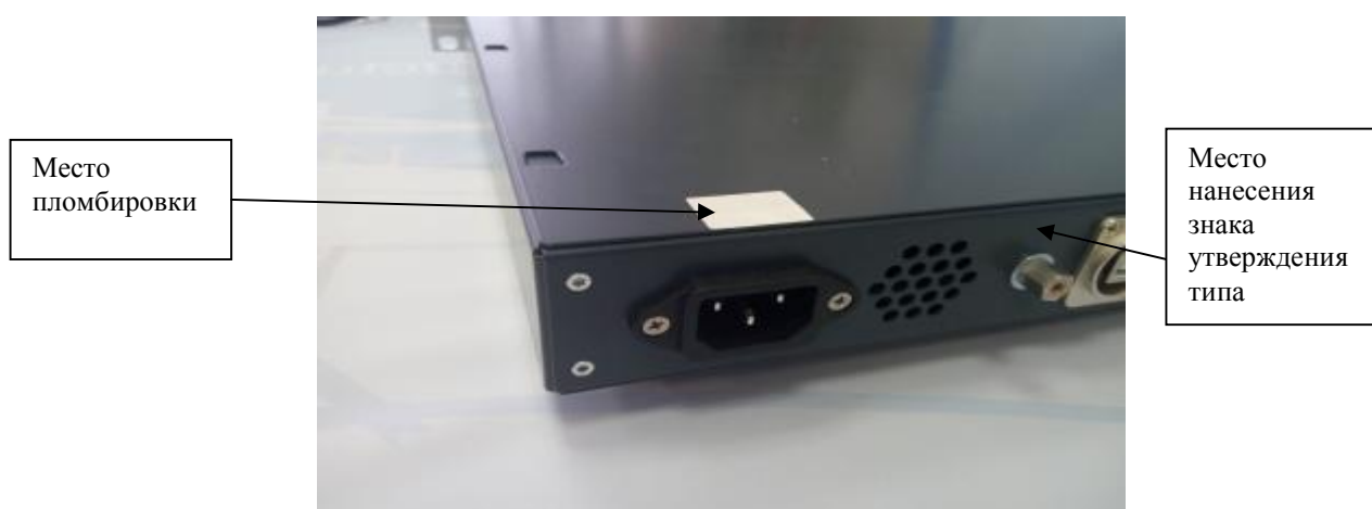
Рисунок 2 – Схема пломбировки измерительных блоков от несанкционированного доступа и место нанесения знака утверждения типа.
