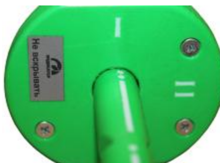
Рисунок 2 – Схема пломбирования насосов
