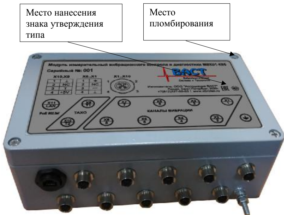
Рисунок 3 - Общий вид, место нанесения знака утверждения типа и место пломбирования от несанкционированного доступа модулей измерительных вибрационного контроля и диагностики MBK01-K65
