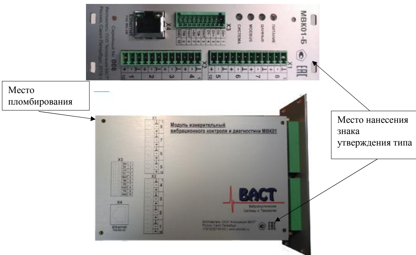
Рисунок 2 - Общий вид, место нанесения знака утверждения типа и место пломбирования от несанкционированного доступа модулей измерительных вибрационного контроля и диагностики MBK01-Б
