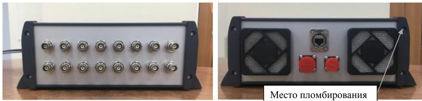
Рисунок 1 – Общий вид дефектоскопов и схема пломбировки от несанкционированного доступа
