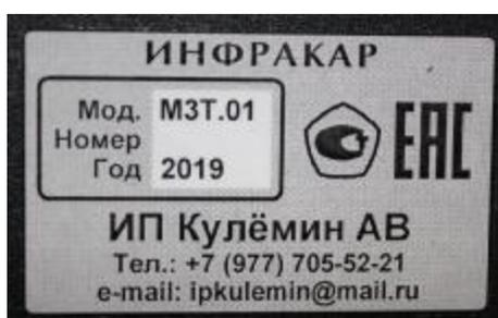
Рисунок 12 - Общий вид типовой идентификационной таблички и место нанесения знака утверждения типа для газоанализаторов производства ИП Кулёмин Андрей Владимирович.
