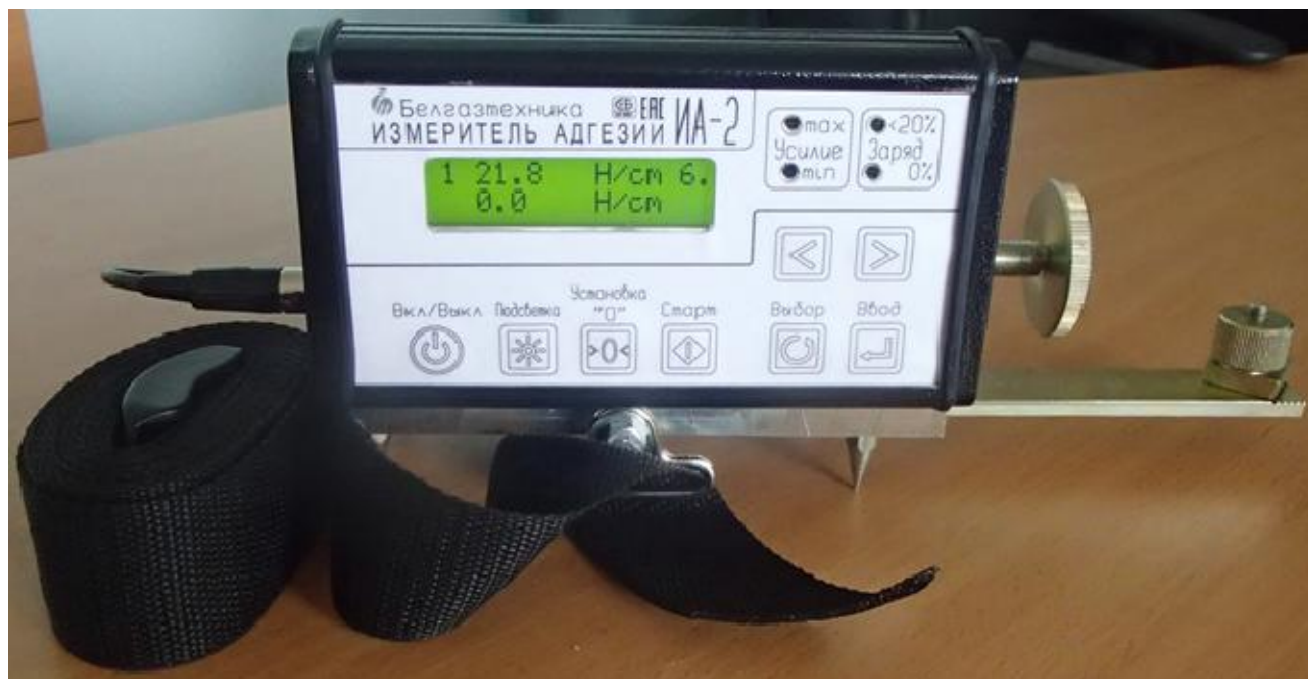
Рисунок 1 - Общий вид измерителя адгезии электронного ИА-2
