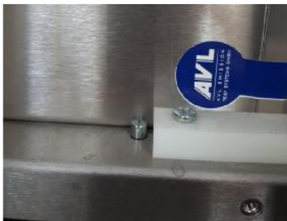
Рисунок 2 – Схема пломбирования корпуса газоанализатора
