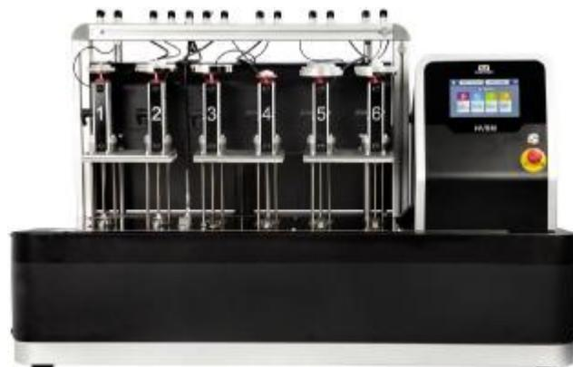
Рисунок 2 – Внешний вид системы для термомеханических испытаний HV6M
